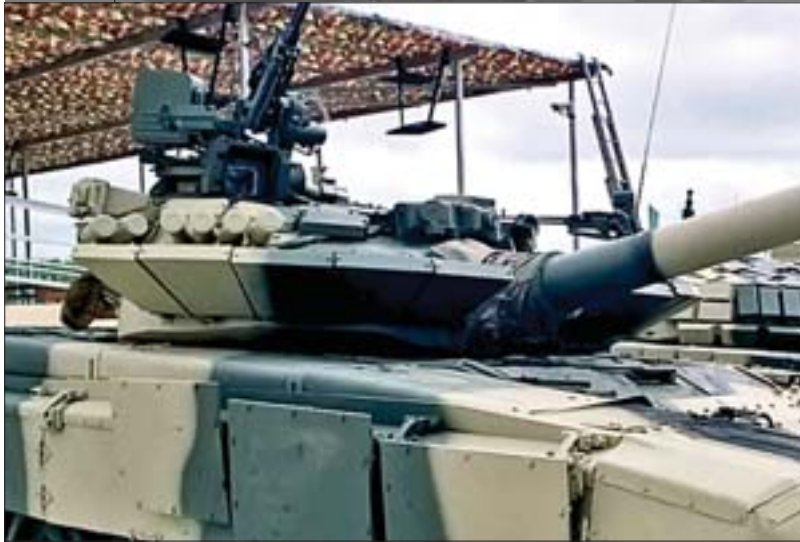
Експлозивно реактивни оклоп „реликт“ на модернизованом тенку Т-72М1М
