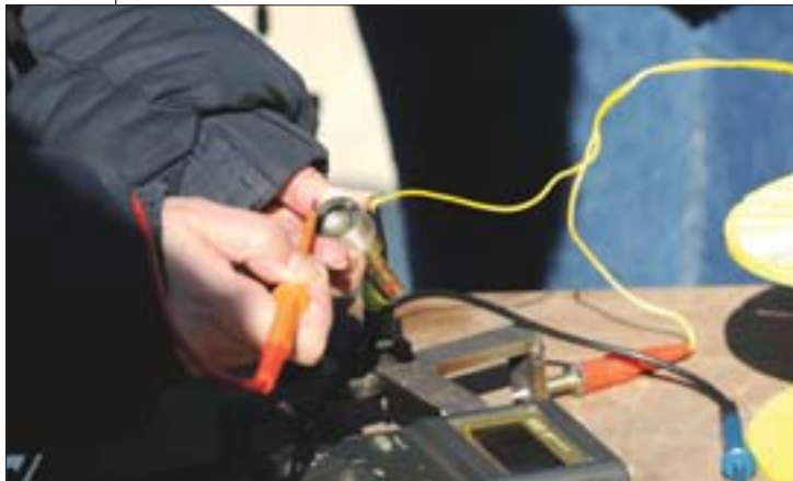
Провера функционисања кола припале
